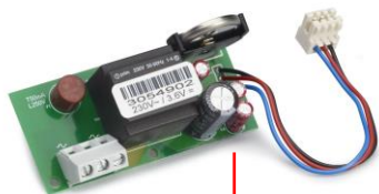
Strømforsyning modul 230V
